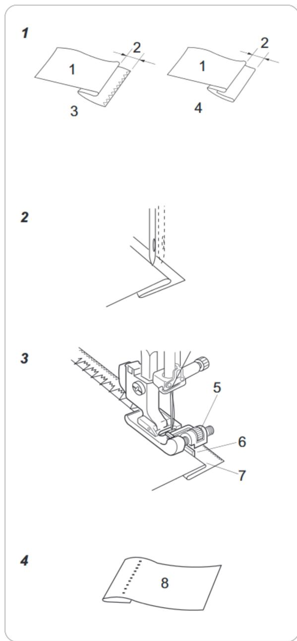
**1** Установка лапки для потайной строчки. Идеальный потайной стежок возможен только на толстых тканях.
