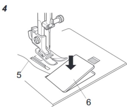
4 Вытяните назад около 15 см нити. Установите пластину челночного отсека. Проверьте, правильно ли Вы вдели нить, сравнивая с подсказкой на крышке челночного отсека .
