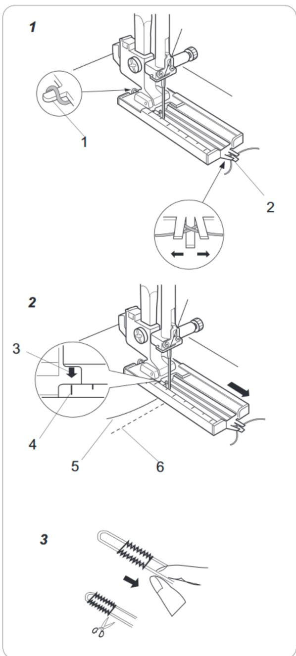
**1** Поднимите лапку для петли, набросьте шнур на крючок сзади лапки.
