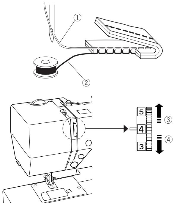
При регулировке натяжения верхней нити, чем больше цифра, тем сильнее натяжение верхней нити. Результат зависит от:
