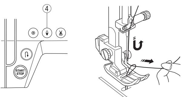
Дважды нажмите кнопку подъёма/опускания иглы и опустите и поднимите иглу, чтобы подхватить нижнюю нить.
